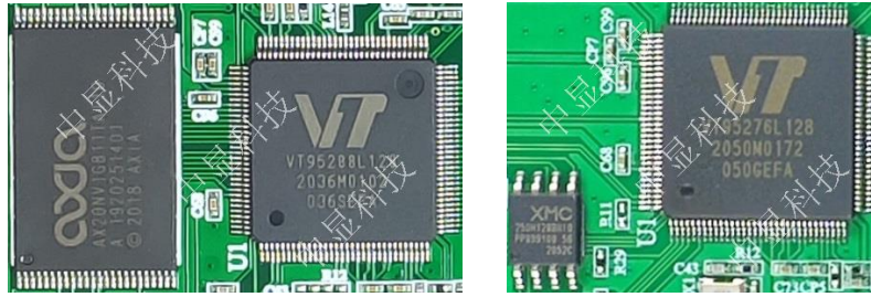
图 3 SDWe 与 SDWa 串口屏核心电路
